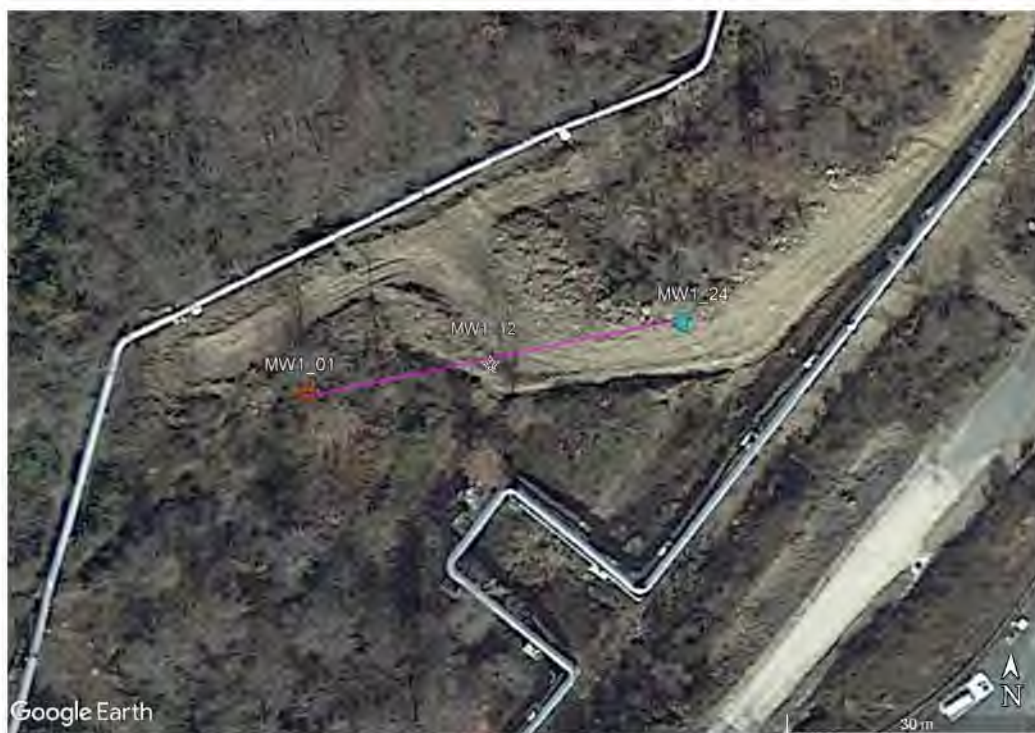
Fig. 9.3 – Frana vapordotto San Paolo. Larderello (PI). Ubicazione dell'indagine MASW (in arancione il punto iniziale, in celeste il punto finale del profilo MASW).
