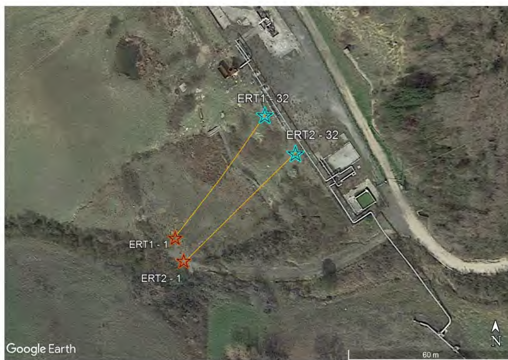
Fig. 8.2 – Postazione Padule 2. Pomarance (PI). Ubicazione della prospezione geoelettriche (in arancione il punto iniziale, in celeste il punto finale del profilo geoelettrico).
