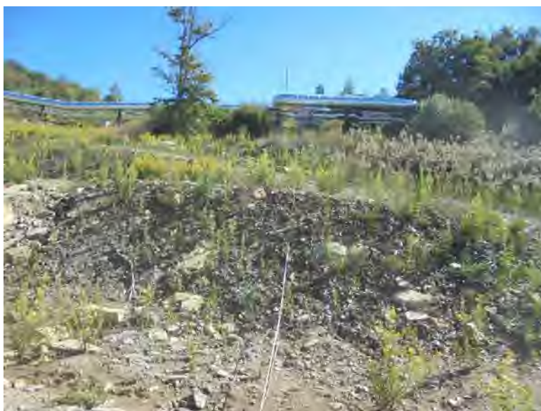
Fig. 8.4 – Frana vapordotto San Paolo. Larderello (PI). Foto del profilo geoelettrico ERT2.
