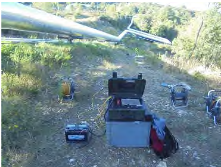
Fig. 8.6 – Frana vapordotto San Paolo. Larderello (PI). Foto del profilo geoelettrico ERT4.
