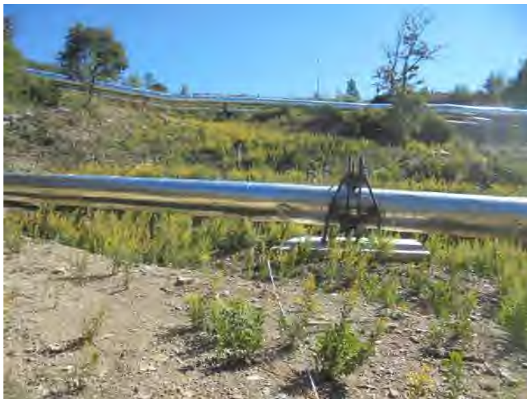
Fig. 8.3 – Frana vapordotto San Paolo. Larderello (PI). Foto del profilo geoelettrico ERT1.
