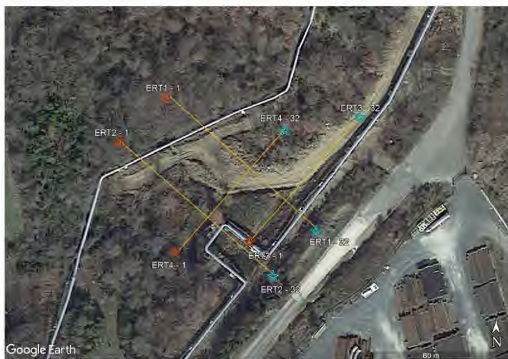
Fig. 8.2 – Frana vapordotto San Paolo. Larderello (PI). Ubicazione della prospezione geoelettriche (in arancione il punto iniziale, in celeste il punto finale del profilo geoelettrico).
