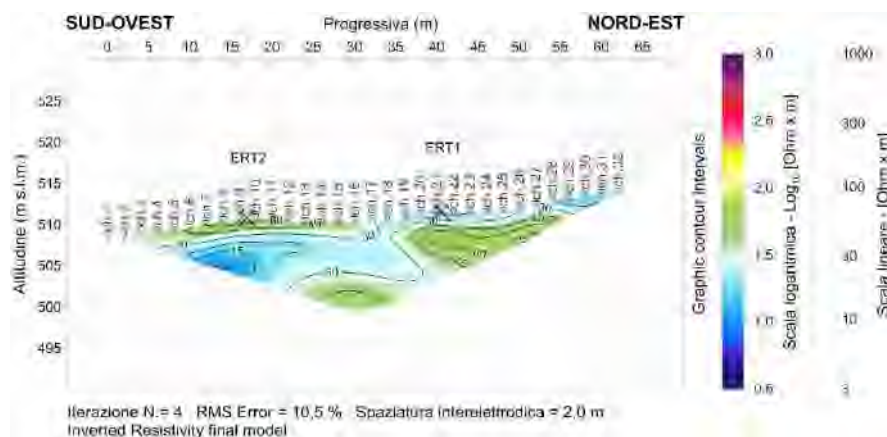
Fig. 8.15 – Frana vapordotto San Paolo. Larderello (PI). Pseudo sezione tomografica 2D di resistività (inversione tomografica). Profilo ERT3.
