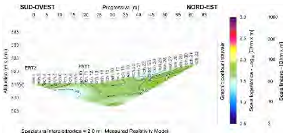
Fig. 8.12 – Frana vapordotto San Paolo. Larderello (PI). Pseudo sezione tomografica 2D di resistività (modello misurato). Profilo ERT 3 .
